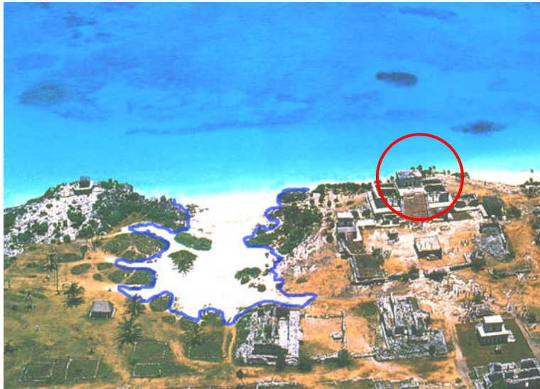
FIGURA III Panorámica aérea parcial del conjunto arqueológico de Tulúm. El edificio del Castillo se identifica por el círculo. Nótese como no hubo edificación en la planicie de inundación por marejadas, algo muy importante si tomamos en cuenta que en la época en que fueron construidos el nivel medio del mar estaba de 0.90 a 1 metro por abajo del actual. Es claro que los arquitectos mayas respetaron la vulnerabilidad del sitio. c
